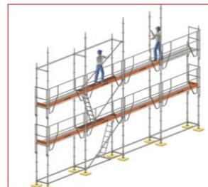
(8) Le montage de l'étage 2 continue avec les montants et plinthes.
